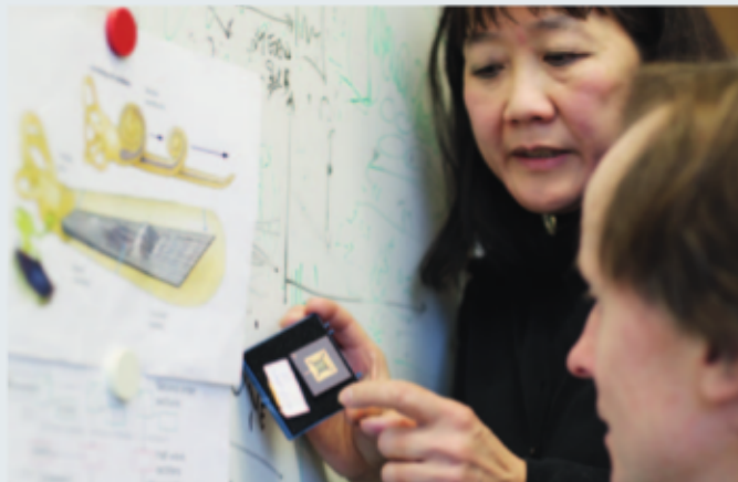
Das Computermodell dient als Grundlage für einen Siliconchip, der gleich aufgebaut ist wie die Hörschnecke. Liu zeigt einem Arbeitskollegen den Chip, den eine externe Firma nach ihrem Modell gebaut hat.
